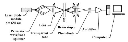
Fig. 1. Laser Doppler velocimeter
